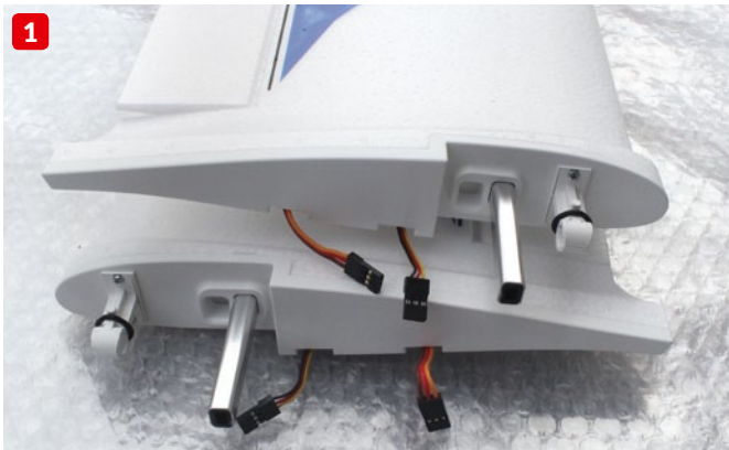
Die Tragflächensteckung und die Wurzelrippe aus Kunststoff versprechen hohe Festigkeit. Trotzdem können sich die Flächen bei harten Landungen vom Rumpf leicht lösen, um Schäden zu vermeiden (1). Die Höhenruderaufnahme ist gut und robust gelöst. Zum Transport kann das komplette Leitwerk abgenommen werden (2)
