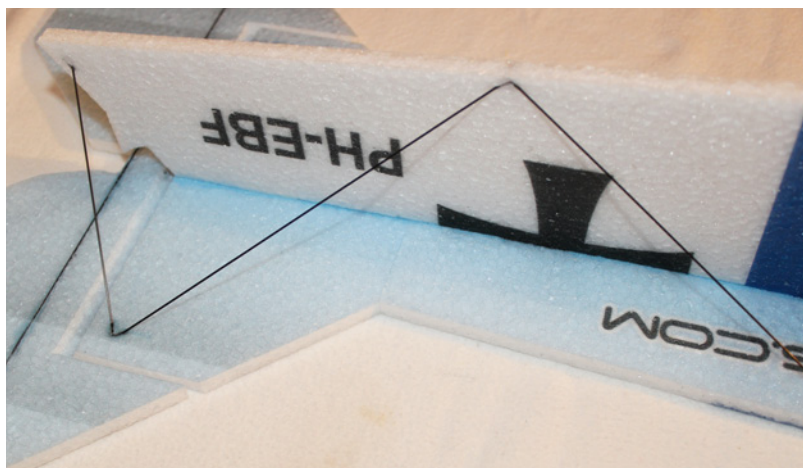
Das Rumpfunterteil wird aufgeklebt und mit Kohlefaserstäbchen abgestützt
