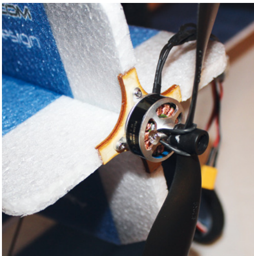
Motor und Propeller bilden die Antriebseinheit. Der Motor wird zuerst mit dem Motorspant verschraubt und anschließend am Rumpf angeklebt
