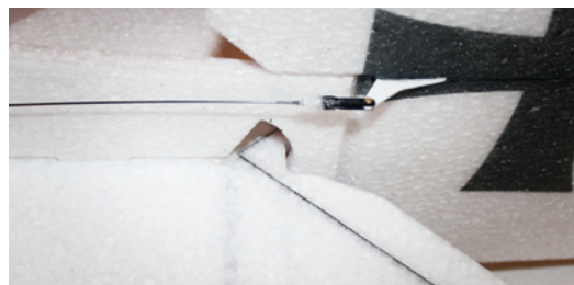
Die Ruderanlenkung des Seitenleitwerks ist sehr leichtgängig und so kann das Ruder weit ausgeschlagen werden
