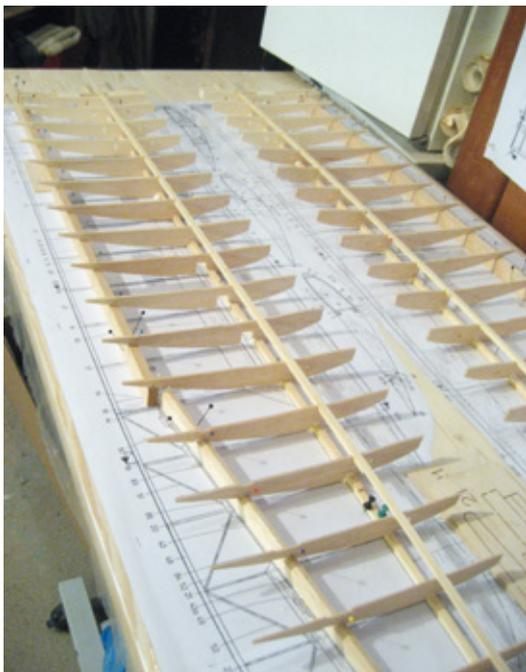
Die Rippen werden auf die Hauptholme aufgesetzt und verklebt. Die Balsaleisten zur Unterlegung unter den Rippen müssen nach Bauplan selbst erstellt werden. Kleine „Füßchen“ an jeder Rippe würden die Arbeit enorm erleichtern
