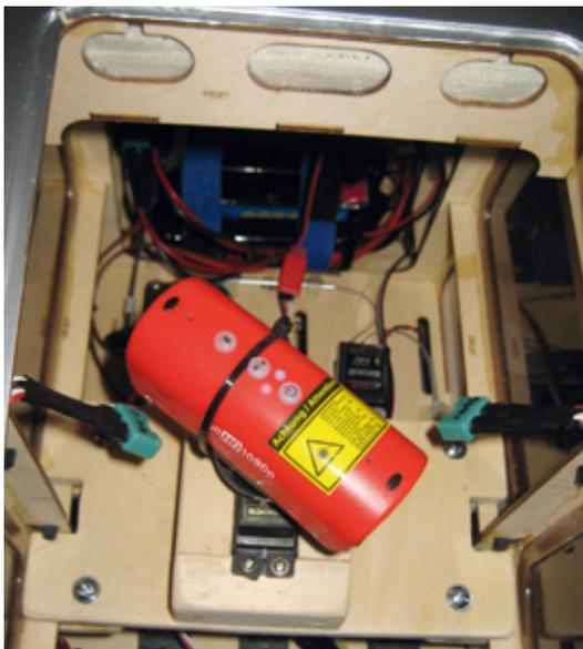
Die Kamera kann mit dem eingebauten Servo nach rechts und links geschwenkt werden, um so Aufnahmen aus Sicht des Piloten aufzuzeichnen
