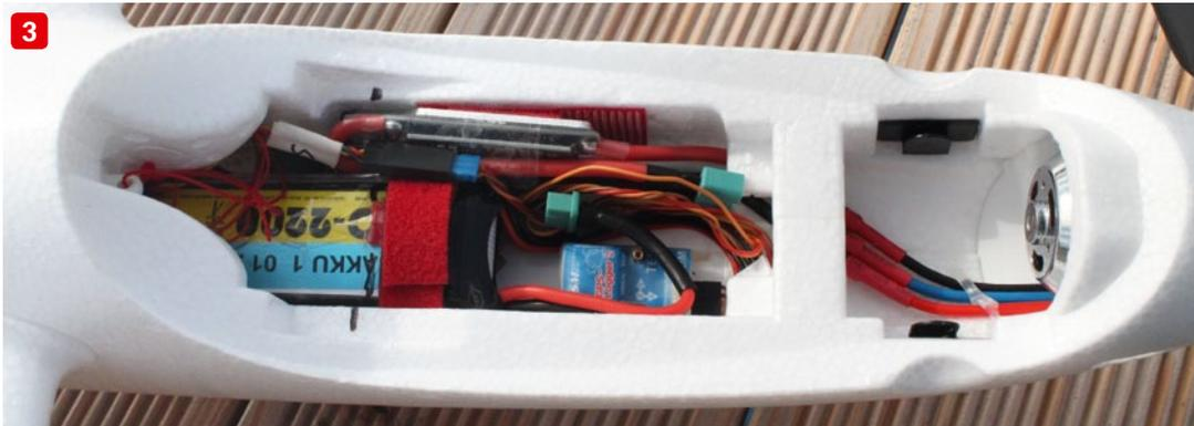
schnell lösbar mit einem Kunststoffbolzen im Rumpf gesichert. Die Servokabel sind in gut vorbereiteten JR-Steckern am Rumpf befestigt, so wie man es zum Beispiel vom EasyGlider kennt. Akku und Empfänger finden im vorderen Bereich ihren Platz. Um den Schwerpunkt sicher einzustellen, befinden sich kleine Noppen unter den Tragflächen. Zum Auspendeln braucht man hier nur mit den Fingerkuppen unterstützen
