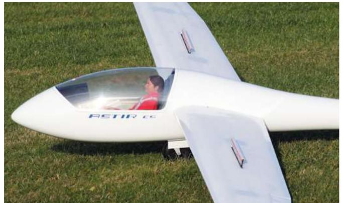
Die doppelstöckigen Störklappen befinden sich nur auf der Oberseite und fahren recht weit aus. So kann Höhe schnell abgebaut werden. Das FEMA-Fahrwerk erhebt den Rumpf etwas höher als im Original, was zum Schutz der Fahrwerksklappen kein Nachteil ist
