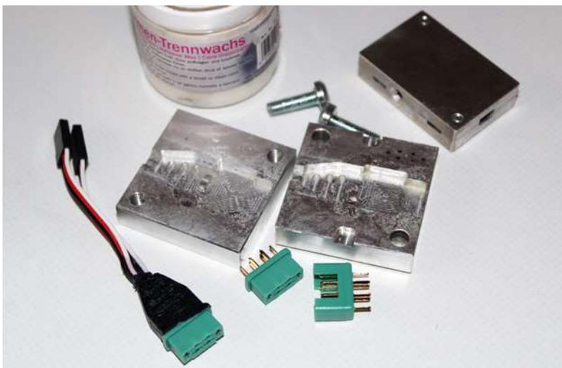
Um MPX-Stecker zu isolieren, kann man mit Hilfe spezieller Formen Heißkleber an den Stecker angießen. Das isoliert nicht nur gut, sondern sieht auch noch schön aus
