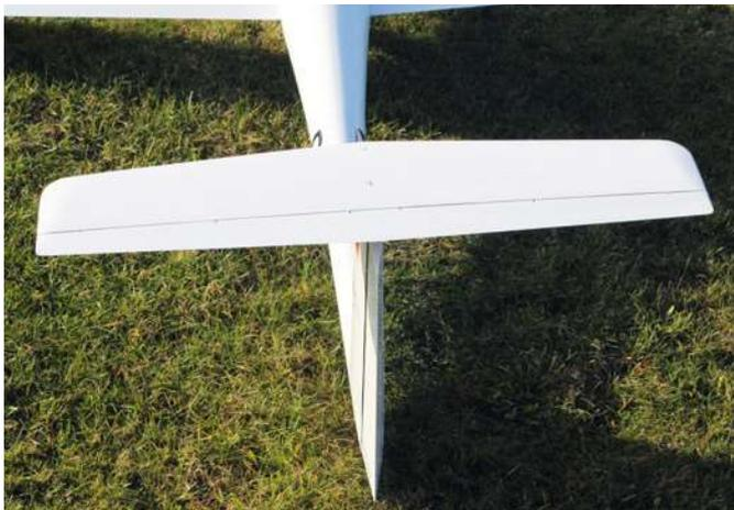
Das Höhenruder ist sehr sorgfältig mit Hohlkehle gefertigt und GFK verstärkt. Es wird mit zwei Schrauben am Seitenruder befestigt
