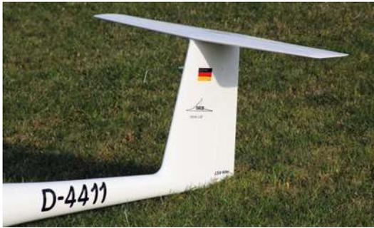
Im Seitenruder wurde eine TEK-Düse installiert. Das Dekor stammt von Plott&Fly und wurde nach eigenen Vorgaben geplottet
