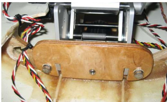
Die Spanten und die Fahrwerksbefestigung wurden aus festem „Multiplex“-Sperrholz hergestellt und laminiert
