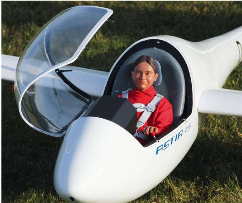
Die Kabinenhaube lässt sich wie im Original nach rechts aufklappen und ist mit einer Seilsicherung vor Überlastung geschützt
