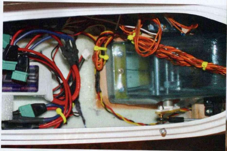
Im vorderen Bereich sind das Schleppkupplungs servo und das Trimmblei untergebracht
