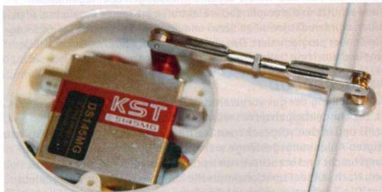
Die Ruderhörner aus Messing und die Servogestänge liegen dem Baukasten schon fertig bei
