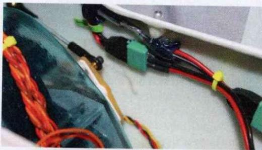
Ein Magnetschalter, der zum Einschalten der Empfangsanlage dient, ist seitlich eingebaut
