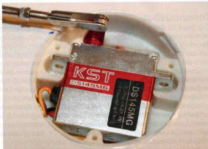
Um die Querruderservos sicher und optisch ansprechend zu befestigen, wurden Servo-Lock-Schnellbefestigungen eingebaut
