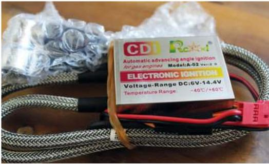
Die Zündanlage ist von hervorragender Qualität und kann Akkus mit Spannungen von 6 bis 14,4 Volt verarbeiten. Mit einem 3s-LiPo können sowohl die Zündung als auch der Anlasser betrieben werden
