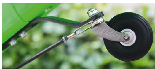
Ein robustes Spornfahrwerk ist bei einem solchen Modell Pflicht. Es wird von einem separaten Servo angelenkt
