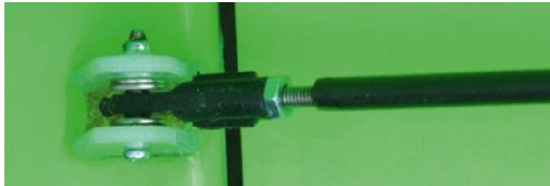
Die Querruderanlenkung ist aus GFK-Ruderhörnern hergestellt und in den Rudern eingearzt
