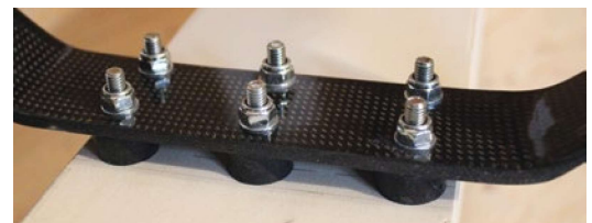
Das CFK-Fahrwerk ist mit sechs Gummidämpfern am Rumpf verschraubt
