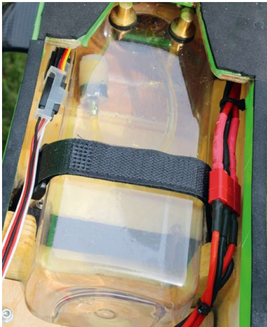
Der transparente 1.000-Milliliter-Tank ist sicher, aber auch ausbaubar im Rumpf verstaut
