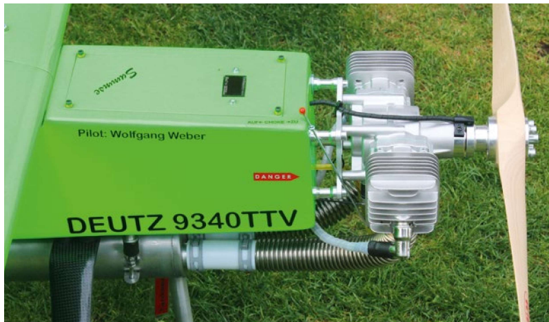
Motor und Schalldämpfer sind außen am Modell verbaut und so optimal gekühlt. Ein Drehzahlmesser wurde in der Deckplatte eingebaut
