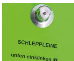
Die Schleppkupplung ist hinter den Tragflächen fest im Rumpf verbaut und kann zwei Schleppleinen gleichzeitig aufnehmen
