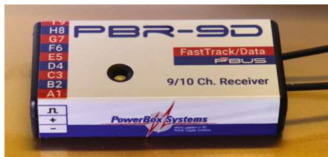
Der PBR-9D ist der absolute Universalempfänger und die erste Wahl. Er glänzt mit zwei Sende- und Empfangseinheiten, neun beziehungsweise zehn Servoanschlüssen, dem P 2 Bus und einem Fast/Track-Anschluss. Er ist natürlich voll telemetriefähig und auch an ihm kann ein iGyroSAT angeschlossen werden
