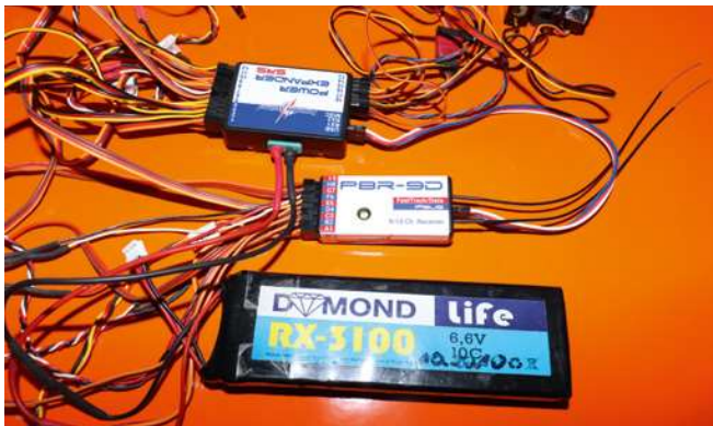
Der Anschluss des Power Expanders SRS erfolgt einfach über ein Patchkabel zum P 2 Bus des Empfängers
