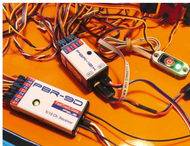
Der Anschluss des PBR-12X erfolgt über den P 2 Bus und eine separate Stromversorgung (Akku oder Akkuweiche). Der Ein-aus-Schalter gehört mit zum Lieferumfang
