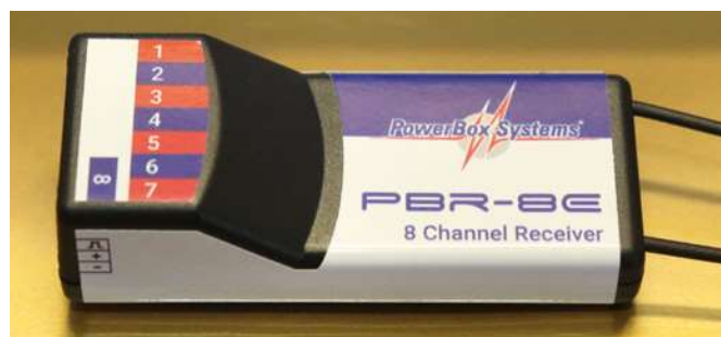
Der PBR-8E ist ein Achtkanal-Empfänger ohne Telemetriefunktion, aber mit zwei Sende- und Empfangseinheiten
