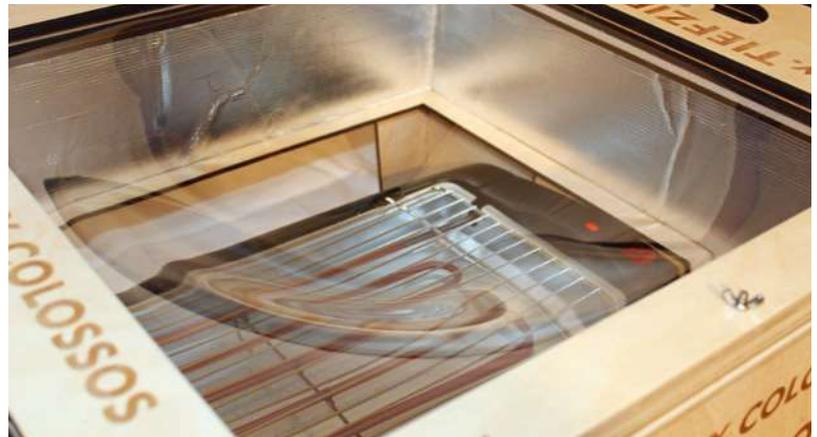
Der Elektrogrill heizt den Kunststoff im Form-Rahmen auf, bis dieser etwas nach unten durchhängt
