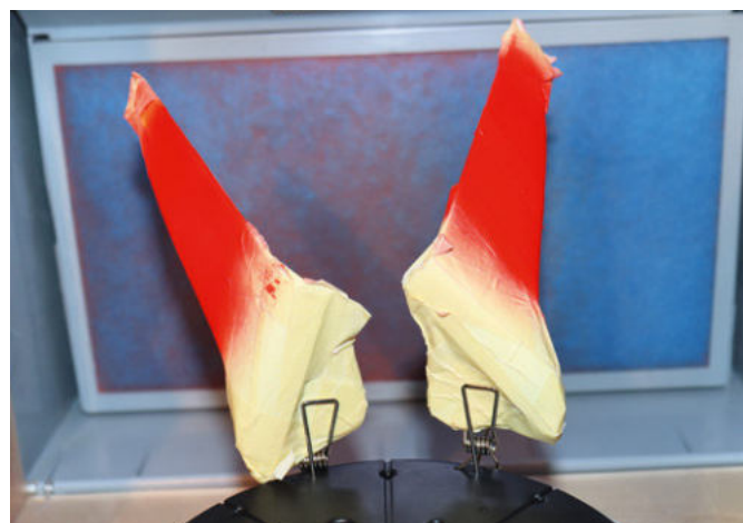
Die Farbe wird in dünnen Schichten nach und nach aufgetragen. Zwischen jeder Schicht ist auf eine gute Trocknung zu achten. Allerdings trocknen die Farben in wenigen Minuten, sodass ein zügiges Arbeiten möglich ist
