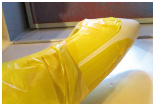
Die Rumpfnase eines GFK-Rumpfs ist abgeklebt und kann nun mit der Airbrushpistole grundiert werden
