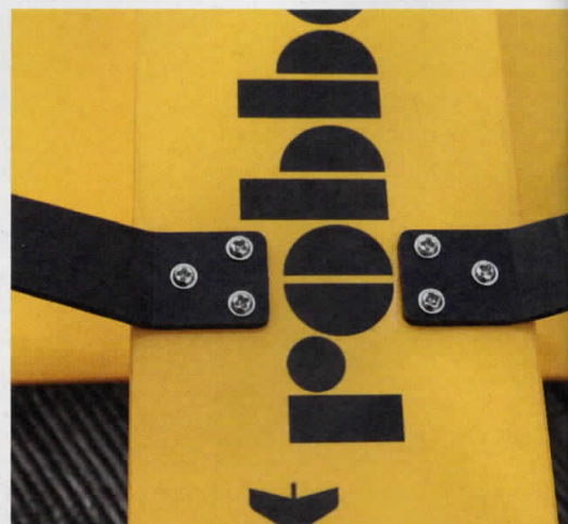
Das Hauptfahrwerk ist gut vorbereitet und braucht vom Erbauer nur noch angeschraubt zu werden
