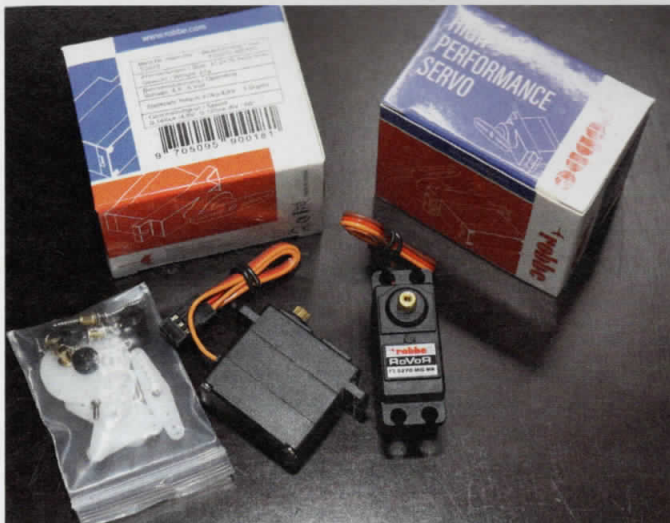
Die robbe-Servos machen einen sehr guten Eindruck und sind mit Metallgetriebe sowie Kugellagern ausgestattet
