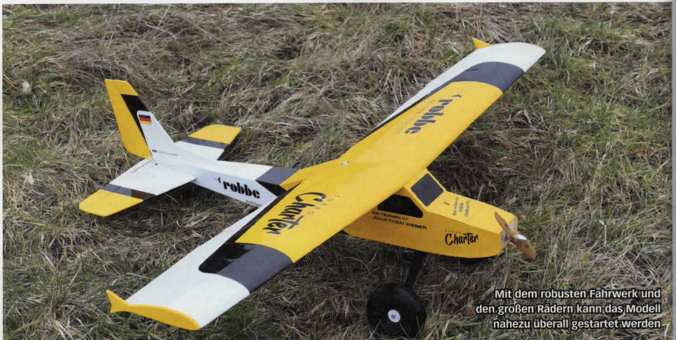
Das robuste Spornfahrwerk ist gefedert und hält auch kräftige Stöße aus
