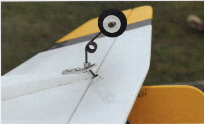
Das robuste Spornfahrwerk ist gefedert und hält auch kräftige Stöße aus
