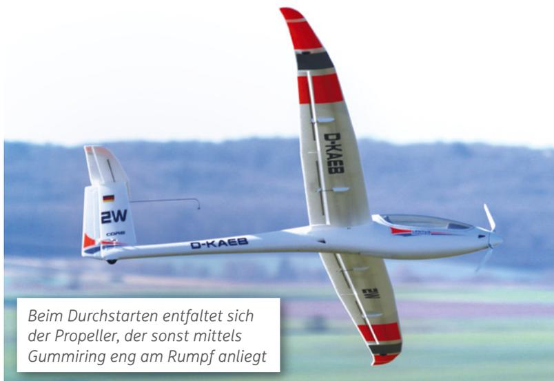
Beim Durchstarten entfaltet sich der Propeller, der sonst mittels Gummiring eng am Rumpf anliegt
