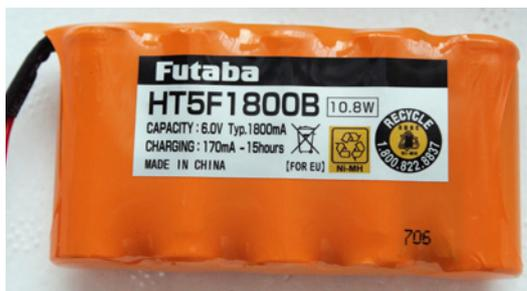
Der mitgelieferte NiMH-Senderakku ist von guter Qualität und hat eine Kapazität von 1.800 Milliamperestunden. Er passt genau und ohne zu wackeln in das Sendergehäuse
