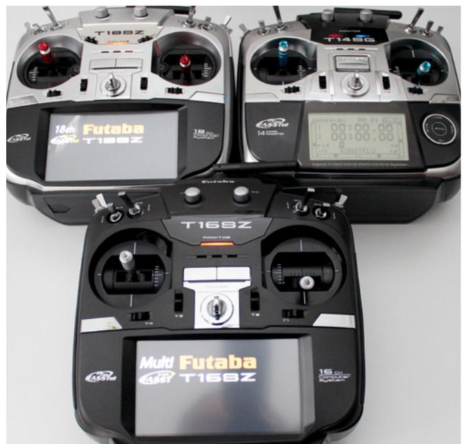
Im Vergleich zur T18SZ (oben links) fehlen der 16er (unten) lediglich zwei Trimm-schalter. Die Steuerelemente stammen von der T14SG
