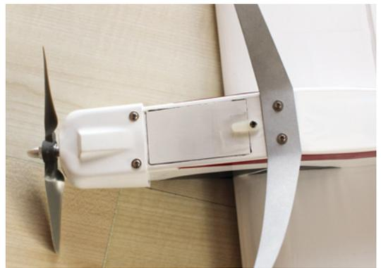
Das Fahrwerk wird einfach mit zwei Gewindschrauben angebracht. Für den Akkuwechsel steht eine große Öffnung zur Verfügung
