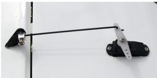
Die Ruderanlenkung ist schnell erstellt. Alle benötigten Teile liegen dem Baukasten in guter Qualität bei
