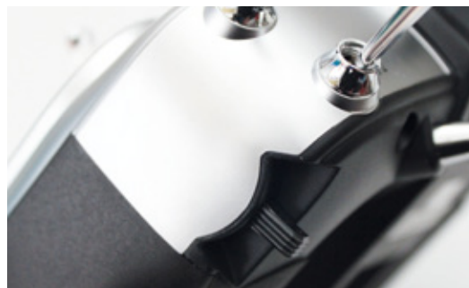
Hier ist der rechte Schieber, Geber RS zu sehen. Er bietet sich gut zur Steuerung von Wölbklappen an. Die Mittelstellung wird akustisch signalisiert
