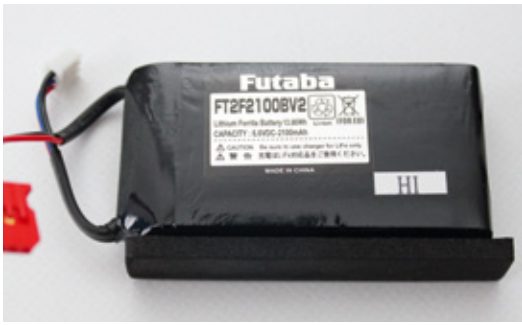
Der LiFe-Akku mit 2.100 Milliamperestunden Kapazität versorgt die T18SZ für etwa 7 bis 8 Stunden mit Strom. Der Moosgummistreifen hält den Akku im Akkufach auf der richtigen Position
