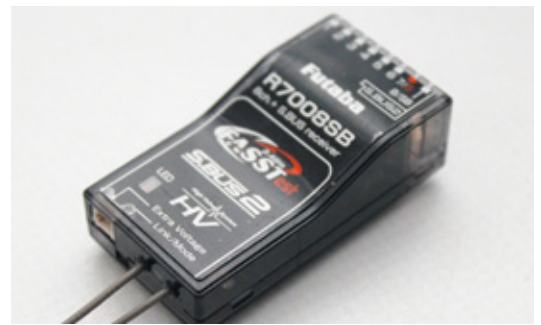
Der beiliegende FASSTest R7008SB-Empfänger verfügt über acht Kanalausgänge
