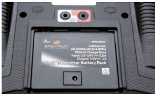
Der Einbau des Lithium-Akkus ist eine fummelige Angelegenheit. Das Anschlusskabel kann unbeabsichtigt gequetscht werden
