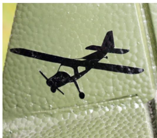
Die Lackierung verändert die Oberfläche des Elapor nur wenig und härtet diese nach Trocknung weiter aus
