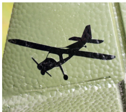
Die Lackierung verändert die Oberfläche des Elapor nur wenig und härtet diese nach Trocknung weiter aus
