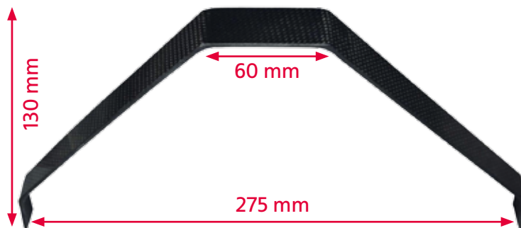
Mit dem robusten Kohle-Fahrwerk, das ausreichend alle Stöße abfedert, ist der Bodenabstand zum Propeller gewährleistet. Mit einer eingeharzten Sperrholzplatte und fünf Spaxschrauben wird eine feste Verbindung geschaffen
