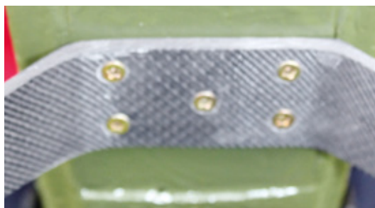
Mit dem robusten Kohle-Fahrwerk, das ausreichend alle Stöße abfedert, ist der Bodenabstand zum Propeller gewährleistet. Mit einer eingeharzten Sperrholzplatte und fünf Spaxschrauben wird eine feste Verbindung geschaffen
