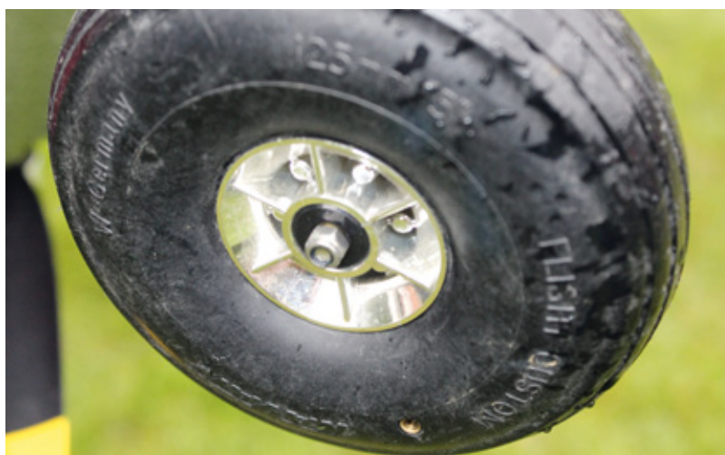
M4-Edelstahlschrauben und Sicherungsmuttern dienen den Kavan-Rädern als Radachsen
