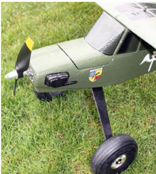
Auf dem Lack lässt sich ein beliebiges Dekor aufbringen. Das neue Fahrwerk mit den großen Bush-Wheels wird an der gleichen Stelle wie das Originalfahrwerk befestigt
