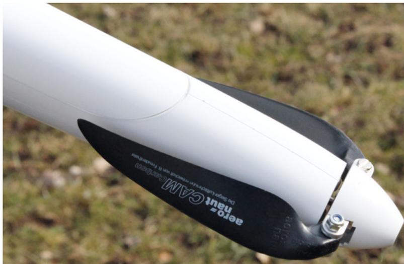
Turbospinner, Klapppropeller und Haube passen perfekt an die Rumpfnase
