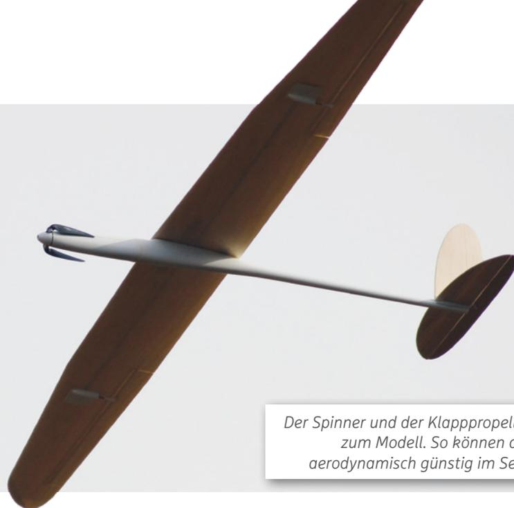
Der Spinner und der Klapppropeller passen bestens zum Modell. So können die Propellerblätter aerodynamisch günstig im Segelflug anklappen
