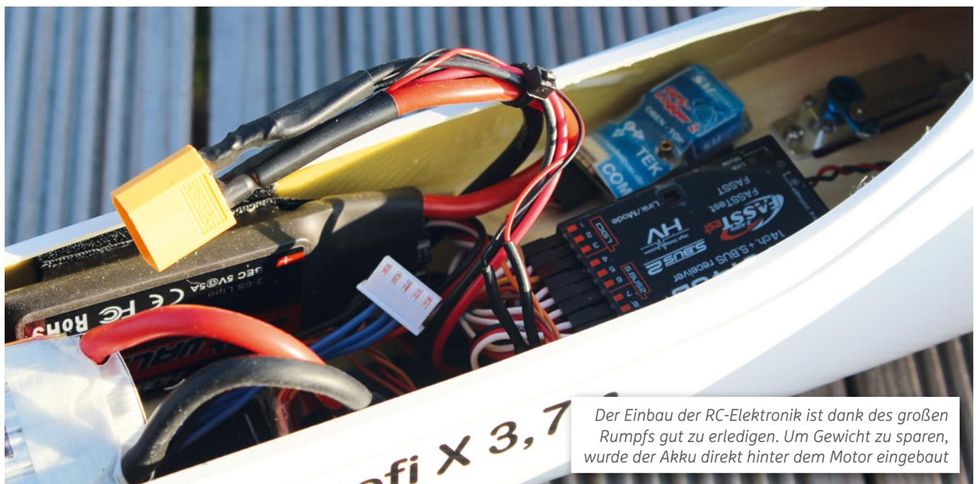
Der Einbau der RC-Elektronik ist dank des großen Rumpfs gut zu erledigen. Um Gewicht zu sparen, wurde der Akku direkt hinter dem Motor eingebaut
