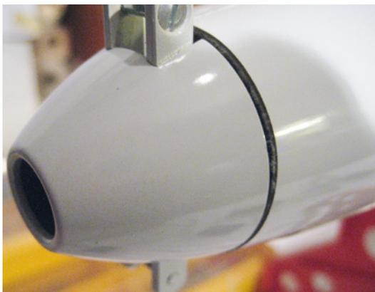
Der eingearztte Motorspannt wird mit einer Schablone vorbereitet und die Löcher für den Motor eingebracht. Der fertig lackierte Spinner passt genau auf die Öffnung
