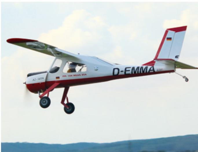
Mit ausgefahrenen Klappen kann die Wilga auch bei kräftigem Seitenwind noch gut gelandet werden
