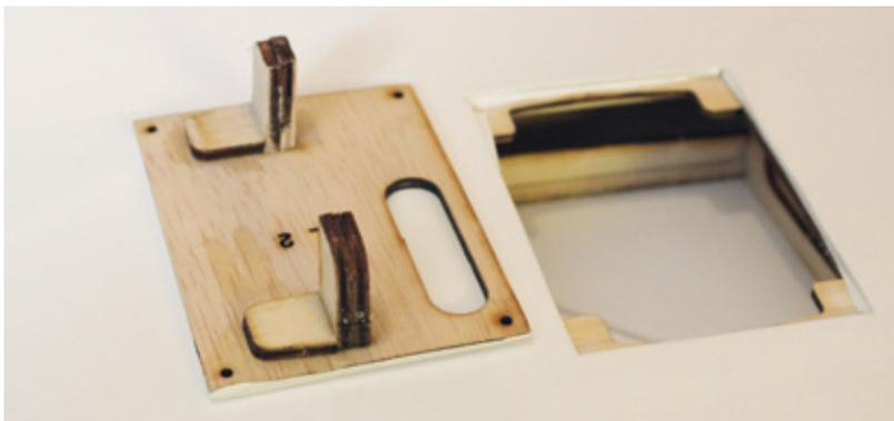
Der Einbau der Flächenservos ist gut vorbereitet
