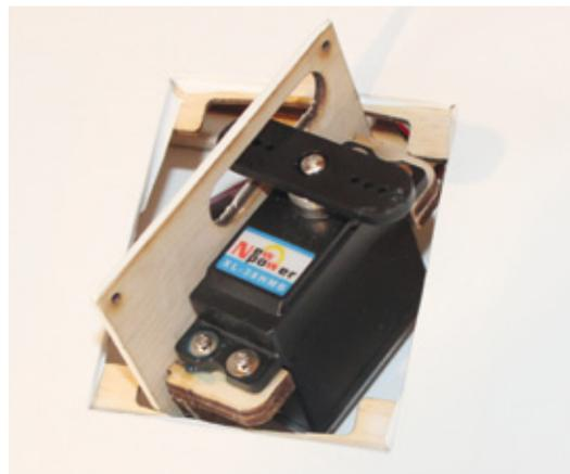
Die Ripmax-Servos passen genau und sind zügig montiert
