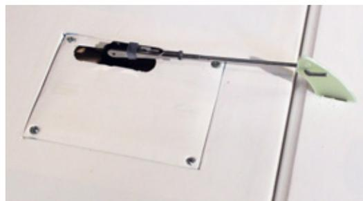
Die fertige Anlenkung mit Z-Anschluss am Ruderhorn
