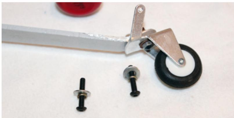
Das Spornfahrwerk ist solide gefertigt und erfüllt alle Anforderungen. Es wird einfach ...
