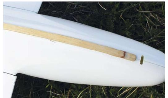
Hinter dem Schlitz an der Unterseite des Rumpfs befindet sich die Schleppkupplung
