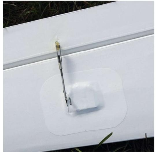
Die Querruderservos wurden mit Schrumpfschlauch überzogen und in den Flächen verklebt
