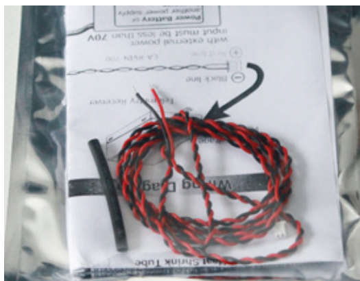
Mit einem optional erhältlichen Empfänger R3008SB und einem Kabelbausatz kann die externe Spannung von Antriebsakkus gemessen und angezeigt werden
