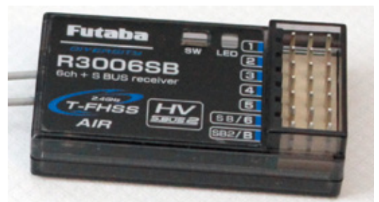
Der mitgelieferte Empfänger der T6K ist ein Sechskanal-T-FHSS-Exemplar. Dieser hat je einen S.Bus- sowie einen S.Bus2-Anschluss und ist telemetriefähig. Leider entbehrt der R3006SB einen Anschluss für externe Spannungsmessung
