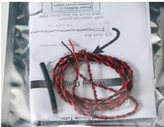
Mit einem optional erhältlichen Empfänger R3006SB und einem Kabelbausatz kann die externe Spannung von Antriebsakkus gemessen und angezeigt werden
