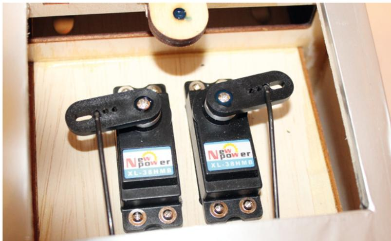
Seiten- und Höhenruderservo sind in einer Halterung auf der Unterseite des Rumpfs eingebaut
