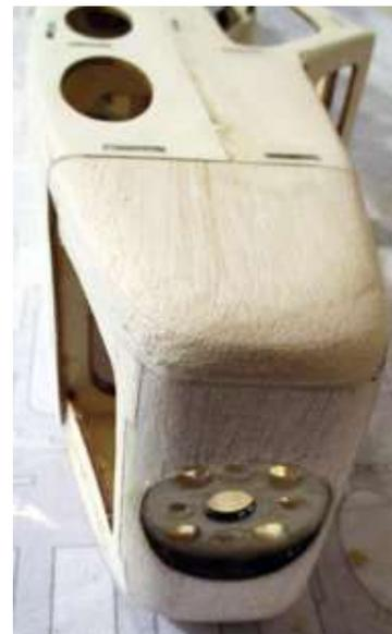
Der Motorspant musste später noch mit GFK verstärkt werden, da er zu schwach dimensioniert ist
