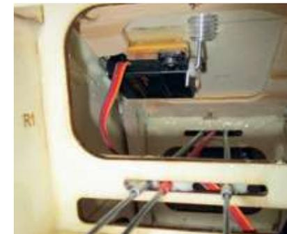
Das Schleppservo ist innen am Servodeckel befestigt und kann notfalls ausgewechselt werden
