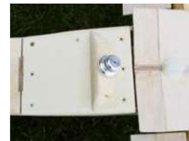
Links: Für die Klappenservos wurde eine spezielle Halterung aus Holz angefertigt und eingelebt. Die Klappen selbst werden von Innen durch eine Rippenöffnung angesteuert. Rechts: Die Schleppkupplung ist eine eigene Konstruktion aus Holz. Sie kann bei Schäden abgenommen werden
