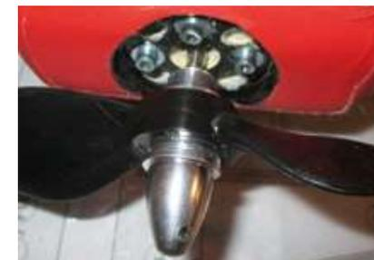
Der Motor ist mit vier Schrauben gut befestigt. Vier weitere Bohrungen sorgen für Kühlluft
