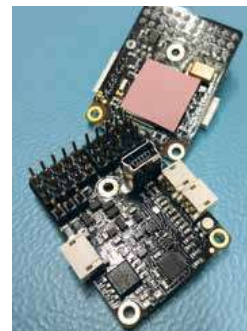
Zur Verwendung kommen besonders hochwertige Materialien, wie Silicon-MEMS-Gyros auf einer vergoldeten Platine, die CNC-gefräst ist
