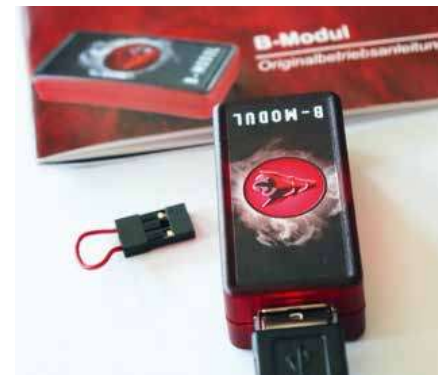
Das B-Modul stellt die Bluetooth-Verbindung zwischen Smartphone und Kreisel her. Das ermöglicht komfortables Einstellen auf dem Flugplatz
