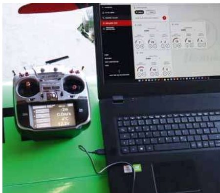
Alle Feineinstellungen können über ein USB-Kabel und einen PC auf dem Flugplatz erfolgen
