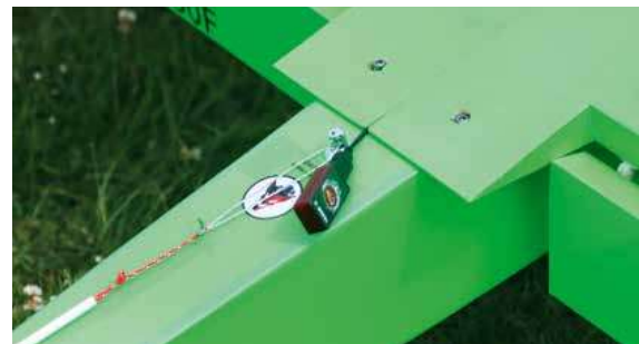
Das B-Modul darf im Flug nicht angesteckt sein. Daher empfiehlt es sich, für die Programmierphase das USB-Kabel nach außen oder leicht zugänglich zu verlegen. So kann das Modul schnell an- und abgesteckt werden
