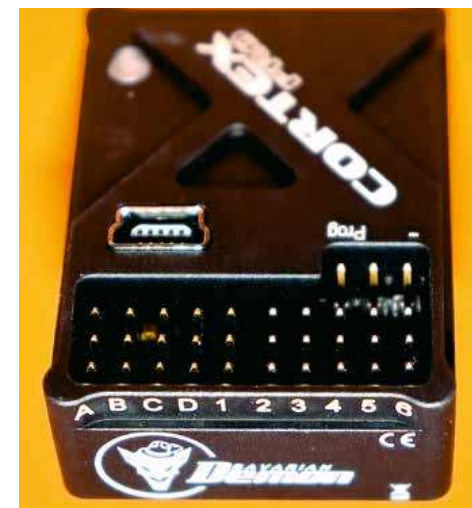
Über den USB-Anschluss kann der Kreisel via PC oder Smartphone programmiert werden
