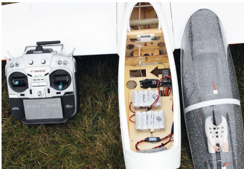
Der Innenausbau des Fox zeigt zwei Empfängerakkus, eine Akkuweiche und den Empfänger. Darüber hinaus ist auch genug Platz um den Fox mit einem E-Motor auszurüsten
