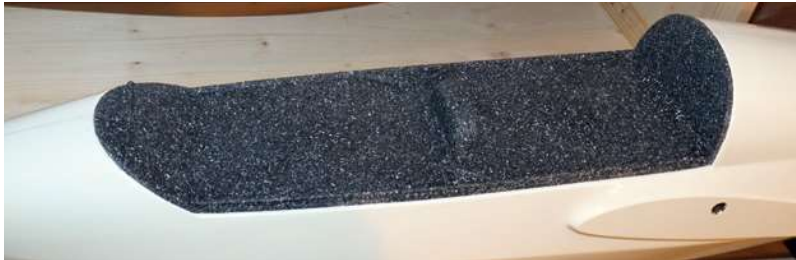
Als dritter Schritt wird das Cockpit mit Strukturlack aus dem Baumarkt besprüht
