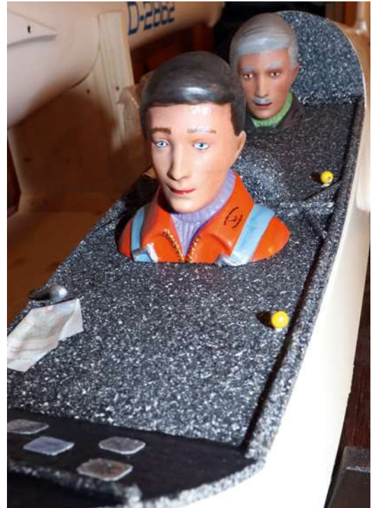
Alle Teile wurden mit Uhu Por oder mit 5-Minuten-Epoxy befestigt. Die Pilotenköpfe mussten zusätzlich mit einer Schraube gesichert werden
