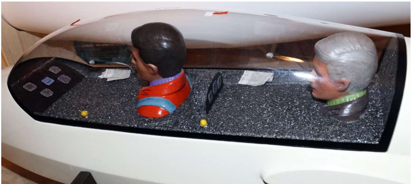
Ein weiteres Detail sind die Wollfäden auf der Haube, die die genaue Fluglage des Seglers angeben
