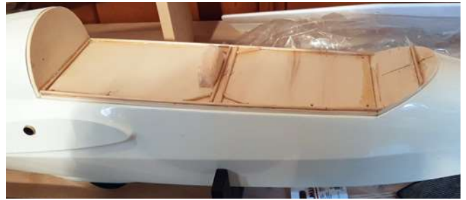
Aus dünnen Rundhölzchen ist der Gitterrahmen der ASK-13 nachempfunden. Die Hölzchen werden einfach mit Sekundenkleber befestigt
