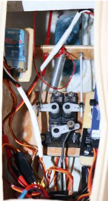
Im Innenraum der Minimoo geht es eng zu. Die drei Servos für Höhe, Seite und Schleppkupplung wurden auf einem Servobrett eingebaut. Rechts und Links darüber befinden sich der Sensor und der Powerbox-Empfänger
