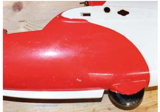
Die Originallackierung wurde entfernt und der Rumpf nass überschleift. Die Landeradtrappe wurde durch ein Vollgummirad der Firma KPO-Modellbau ersetzt
