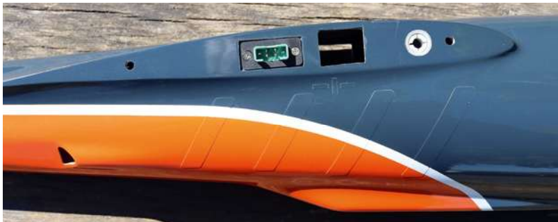
Tragfläche und Rumpf werden mit dem bekannten Multilock-System verbunden. Am Rumpf können eine Schwerpunktangabe und Griffmulden für den sicheren Start erfühlt werden
