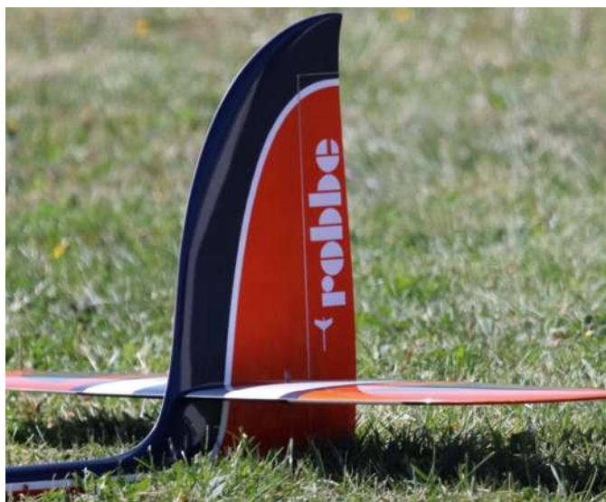
Das Höhenruder ist als Pendelruder ausgeführt und sehr wirksam
