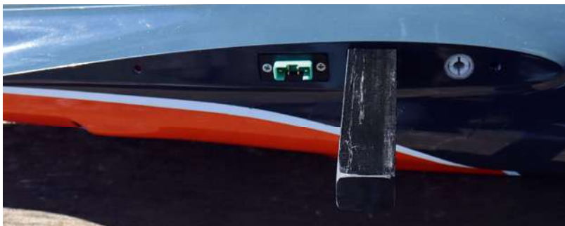
Der EVOA 3.0 ist mit einer schwimmenden Steckung und einem kräftigen CFK-Vierkantverbinder ausgestattet. Die elektrische Verbindung übernehmen MPX-Verbinder
