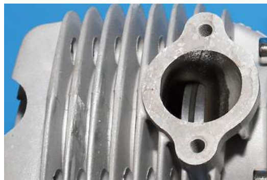
Die Kolben sind mit einem Kolbenring ausgestattet. Sieht man genau hin, ist ein Teil der Keramikbeschichtung zu erkennen
