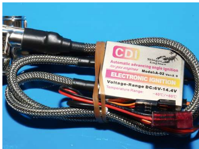
Dem Motor liegt eine zuverlässige CDI-Zündung mit einem Spannungsbereich von 6 bis 14,4 Volt bei
