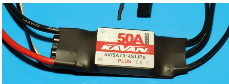
Der Anlasser wird über einen 50-Ampere-Regler angetrieben, der ebenfalls dem Lieferumfang beiliegt
