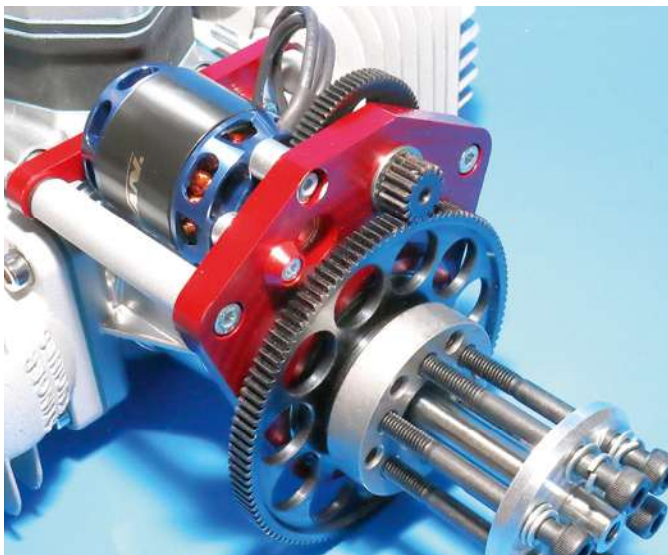
Die Anlassmechanik ist sehr sauber gefertigt und wird über einen bürstenlosen Elektromotor angetrieben
