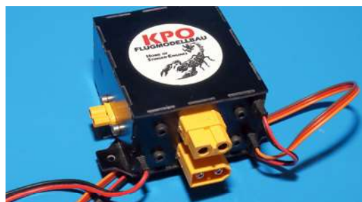
Die Blackbox beinhaltet den Killswitch für den Motor und schaltet Zündung und Anlasser gleichzeitig ein und aus
