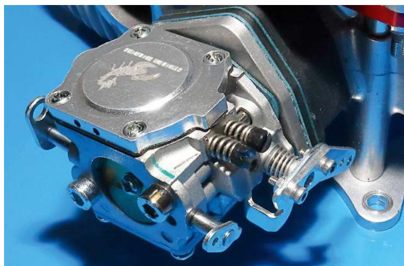
Der Gashebel ist mit Feder ausgeführt. Das bringt ein hohes Maß an Sicherheit, sollte das Gasservo einmal ausfallen
