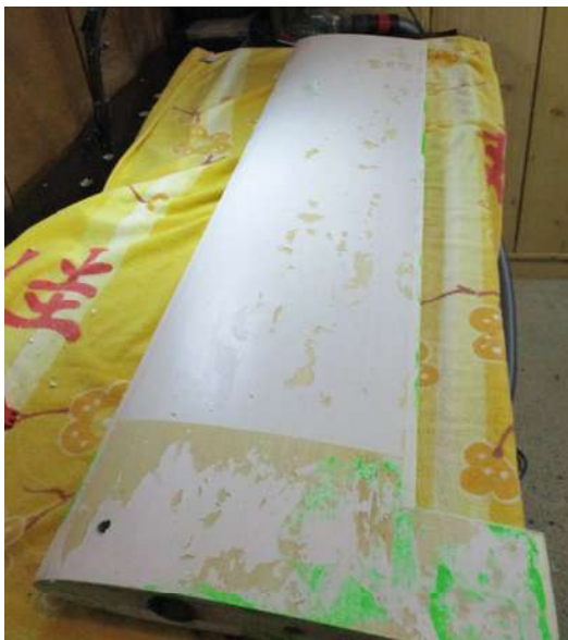
Die Tragflächen, sowie alle restlichen Bauteile, mussten mühsam von der alten Folie befreit werden. Zurück blieb der alte Klebstoff auf den Oberflächen
