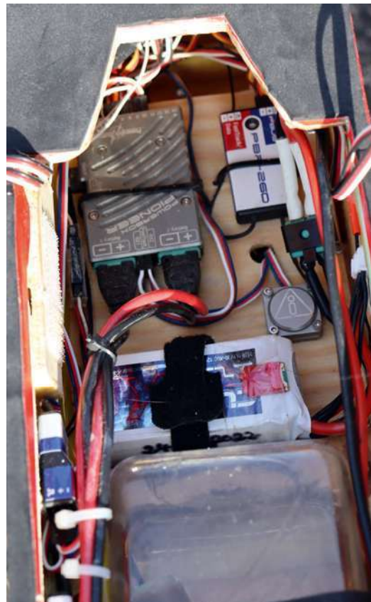
Die RC-Elektronik besteht aus der Powerbox Pioneer, einem Powerbox PBS 26D-Empfänger, dem iGyro-Sat-Kreiselsystem und weiteren Sensoren
