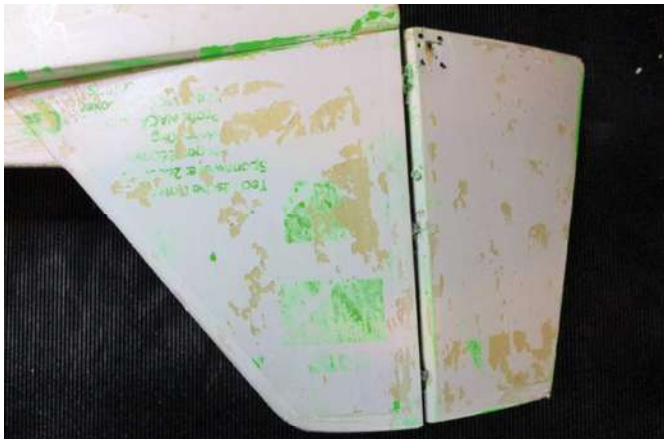
Auch am Rumpf und den Rudern musste der Klebstoff mühsam mit Aceton entfernt werden
