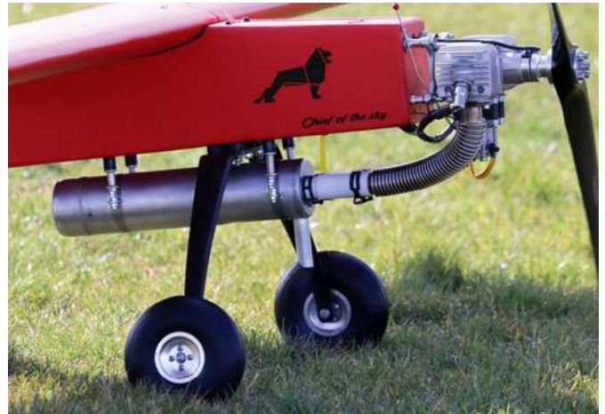
Lediglich ein neuer Schalldämpfer und neues Befestigungsmaterial mussten angebracht werden
