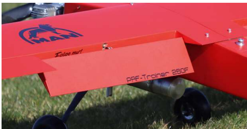
Die Landeklappen können weit ausgefahren werden und ermöglichen so langsame und kurze STOL-Landungen
