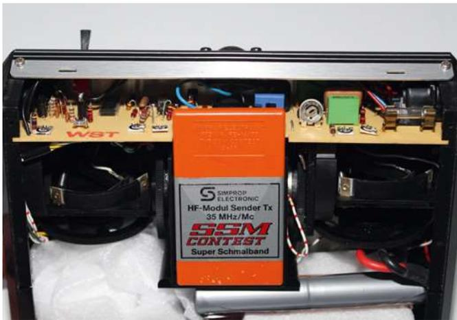
Die Elektronik der SSM-Contest war überschaubar und das auswechselbare AM-Modul eine zukunftsweisende Entwicklung
