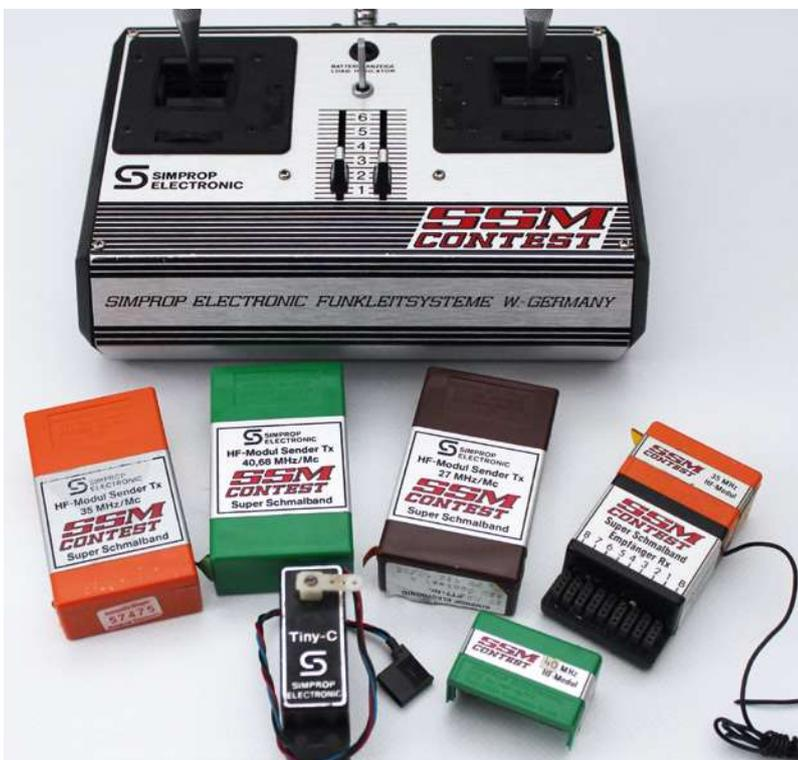
Für diesen Sender konnten Module in den Frequenzbändern 27, 35 und 40 Megahertz geliefert werden. Ebenso standen diese Module auch für den Achtkanal-Empfänger zur Verfügung
