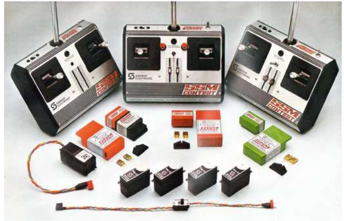
Das Katalogfoto der Simprop SSM-Contest zeigt die drei verschiedenen Sender, die zur Auswahl standen. Die Vierkanal-Sender konnten aber später im Service auch auf acht Kanäle erweitert werden
