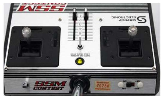
Die Simprop SSM-Contest hatte eine grünes Blinklämpchen, um den Ladezustand des Senders anzuzeigen, und eine Kugelantenne
