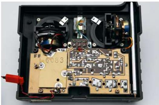
Das Innenleben der robbe Kompakt war sehr einfach gehalten, die Knüppelaggregate ohne Hallsensoren und ohne Kugellager gefertigt
