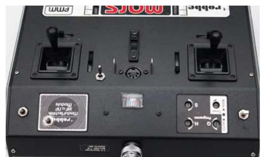
Für den Sender standen einige Ausbaumodule, wie Kippschalter oder Schieberegler, aber auch Erweiterungsmodule zum Selbsteinbau zur Verfügung
