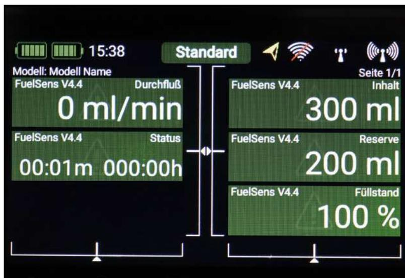
Die Anzeige der Core informiert ausführlich über den aktuellen Tankfüllstand und die Durchflussmenge
