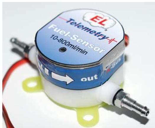
Für die Anschlüsse des Sensors M an das Kraftstoffsystem gibt es verschiedene Lösungen. Hier können auch Anschlüsse von Festo genutzt werden
