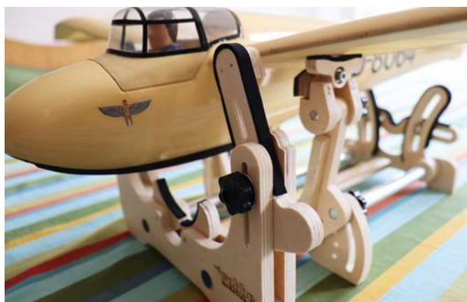
Mit der Schwerpunktwaage lassen sich die Modelle sehr fein und genau einstellen
