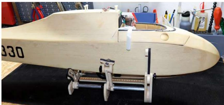
Der fertige Ro-Spider ist ein solider und universeller Modellhalter, an dem alle Einstellungen werkzeuglos gemacht werden können
