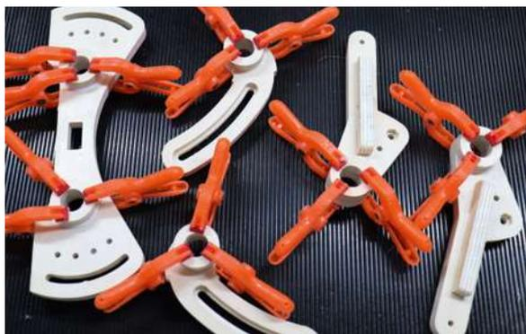
Die mitgelieferten Ringe müssen auf die entsprechenden Bauteile aufgeleimt werden. Anschließend sollten die Passungen nochmals überarbeitet werden
