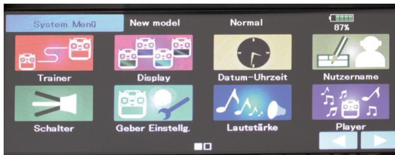
Das System-Menü verfügt über zwei Seiten, auf denen man die Grundeinstellungen des Senders vornehmen kann
