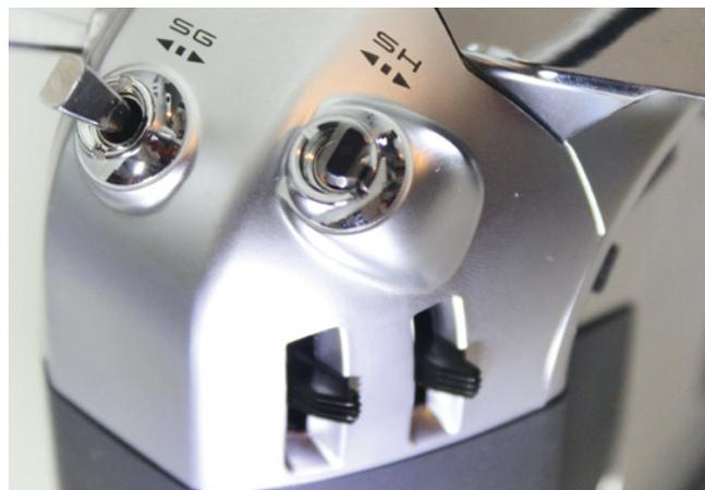
Auf jeder Seite des Senders sind jeweils zwei unterschiedliche Schalter und zwei analoge Schieberregler untergebracht
