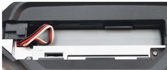
Am Boden der T32MZ befindet sich der Deckel zum Akkuschlacht. Der Hardcase-Akku ist ein LiPo mit 3,8 Volt und hat 6.600 Milliamperestunden Kapazität. Daneben ist der Slot für die Micro-SD-Karte zu finden
