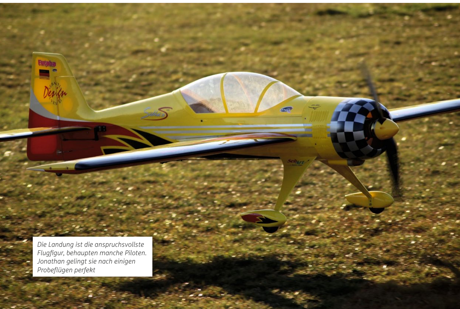
Der 75-Kubikzentimeter-Motor und der Dreiblattpropeller bringen reichlich Leistung und ermöglichen problemlos Motorkunstflug
