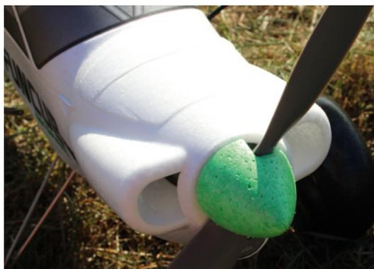
Der Schaumspinner wird einfach auf eine Kunststoffhalterung aufgesteckt und ist schnell abnehmbar
