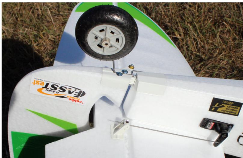
Die Anlenkung der Ruder erfolgt über im Rumpf eingebaute Servos. Die neue Lagerung des Heckfahrwerks ist zweckmäßig und gut gelungen
