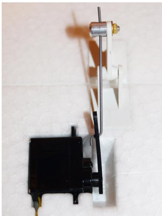
*Die Landeklappen-Servos sind fertig eingebaut und angeschlossen. Die neuen Klappenscharniere sind deutlich robuster als die alten*
