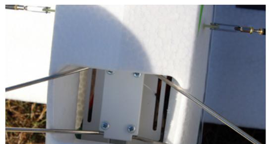
Die Flügelstreben werden einfach mit dem Multitool in GFK-Laschen eingeklinkt. Der Montageschacht für das Hauptfahrwerk dient gleichzeitig als Kühlluftaustritt
