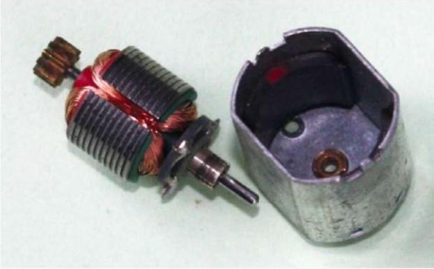
Zerlegter Servomotor mit Eisenanker
