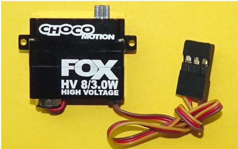
Kompaktes HV-Servo. Die Aufschrift verrät noch nicht den Arbeitsspannungsbereich
