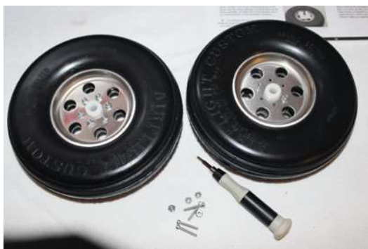
Die Räder sind ein eigener kleiner Bausatz. Die festen Gummiräder sind robust und tragen das Gewicht des Modells problemlos
