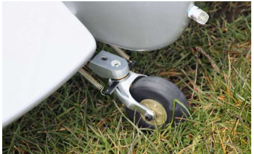
Das Spornfahrwerk ist sehr robust und mit Blattfedern versehen
