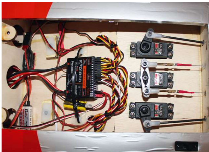
Für die Empfangsanlage und die Servos für das Leitwerk gibt es einen eigenen kleinen Raum auf der Unterseite des Modells. Er wird mit einem schraubbaren Wartungsdeckel verschlossen
